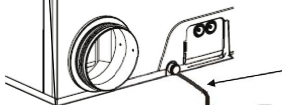
Le conduit de condensats doit impérativement maintenir la pente pour l'écoulement correct des condensats vers l'égout et disposer d'un siphon bien dimensionné.
