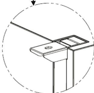
Structure métallique pour fixation au plafond
