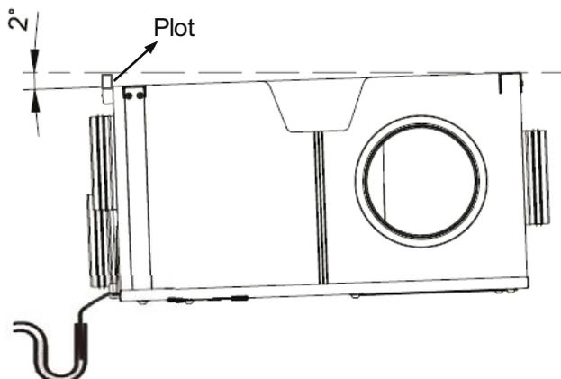
Il faut respecter le pente d'installation vers la sortie de condensats, comme indiqué. Utiliser les plots fournis pour assurer la pente adéquate.
