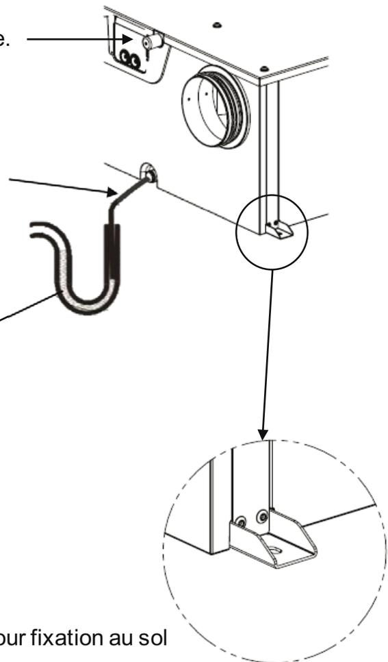
Structure métallique pour fixation au sol
