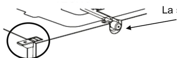
La sortie qui n'est pas utilisée doit être bouchée.
