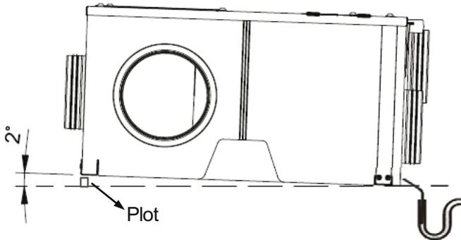
Il faut respecter le pente d'installation vers la sortie de condensats, comme indiqué. Utiliser les plots fournis pour assurer la pente adéquate.
